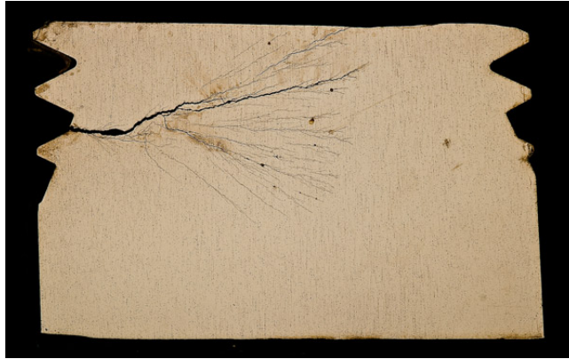
Abbildung 1: Spannungsriss unter Kerbwirkung an einem Bolzen [6]
